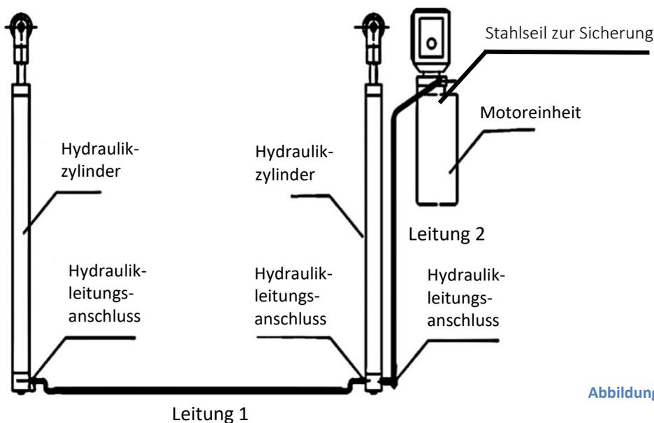
Abbildung: Montage der Hydraulikleitung
