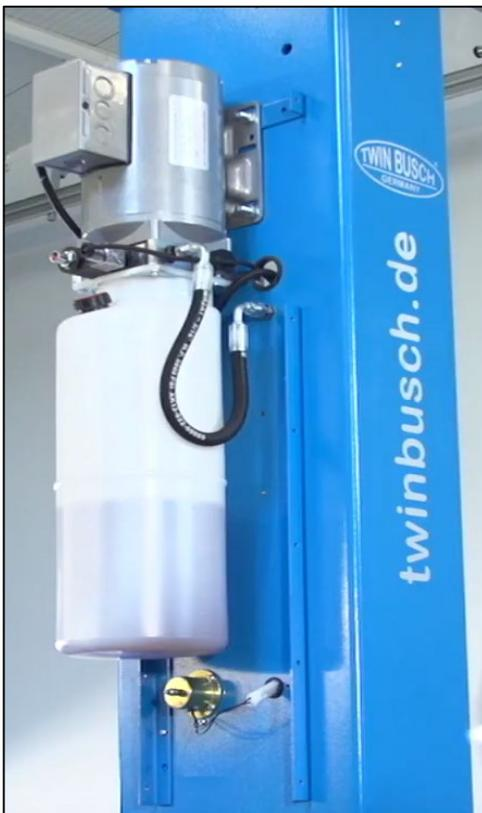
Abbildung: Montage der Motoreinheit
