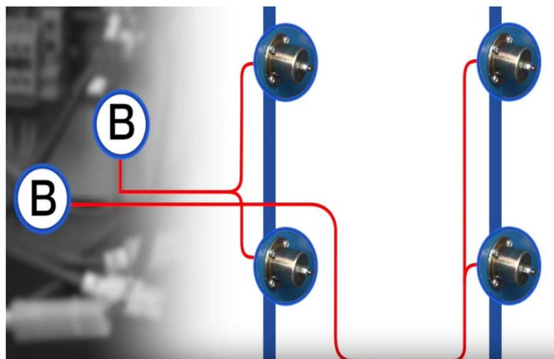
Abbildung: Verbindungen der Elektromagnetentriegelung
