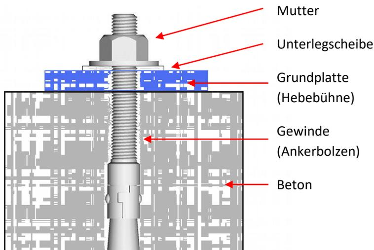
**Anzugsdrehmoment der Ankerbolzen beträgt: 105 Nm**
