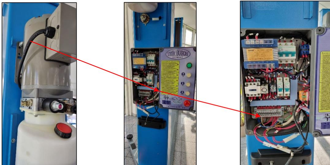
Abbildung: Verbindung der Stromversorgung zu Bedieneinheit
