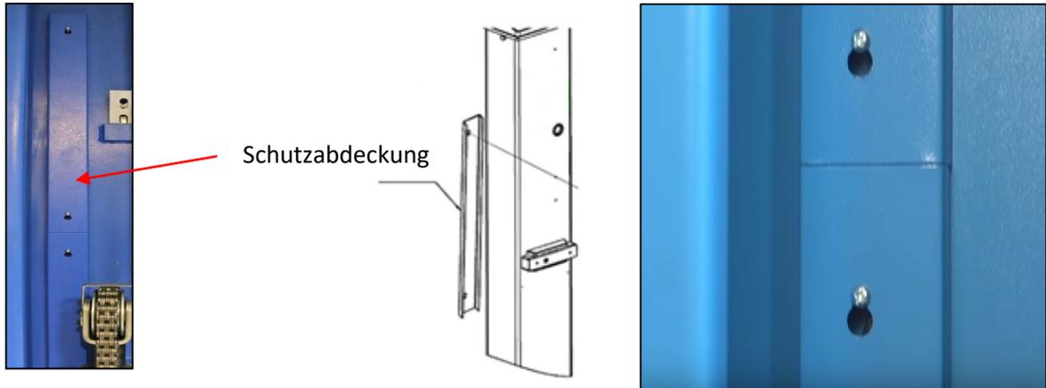
Abbildung: Montage der Schutzabdeckungen
