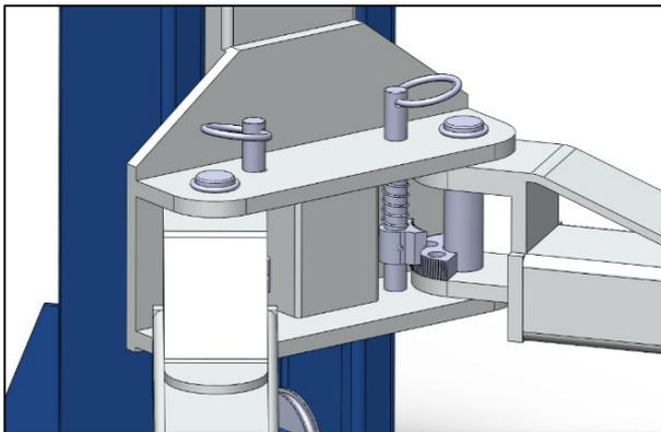
Abbildung: Montage der Tragarme am Hubschlitten
