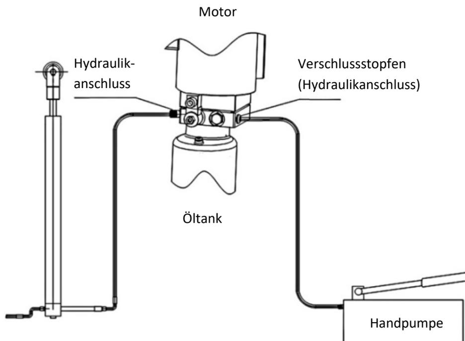
Abbildung: Verbindung der Handpumpe
