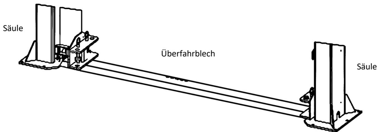
Abbildung: Montage des Überfahrblechs
