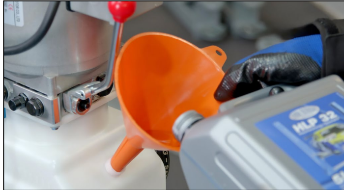
Abbildung: HLP 32 einfüllen
