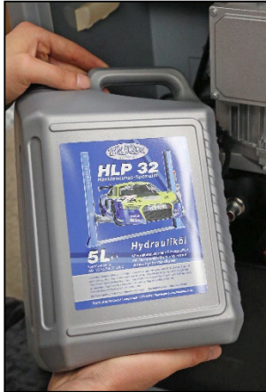
Abbildung: HLP 32 einfüllen
