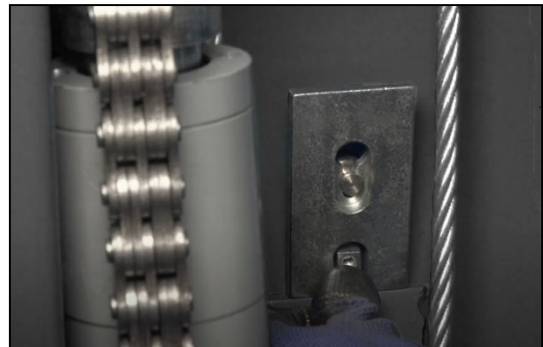
Abbildung: Sicherheitsraste mit Befestigungswinkel
