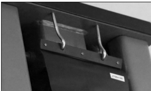
Abbildung: Montage der Säulenschutzabdeckung
