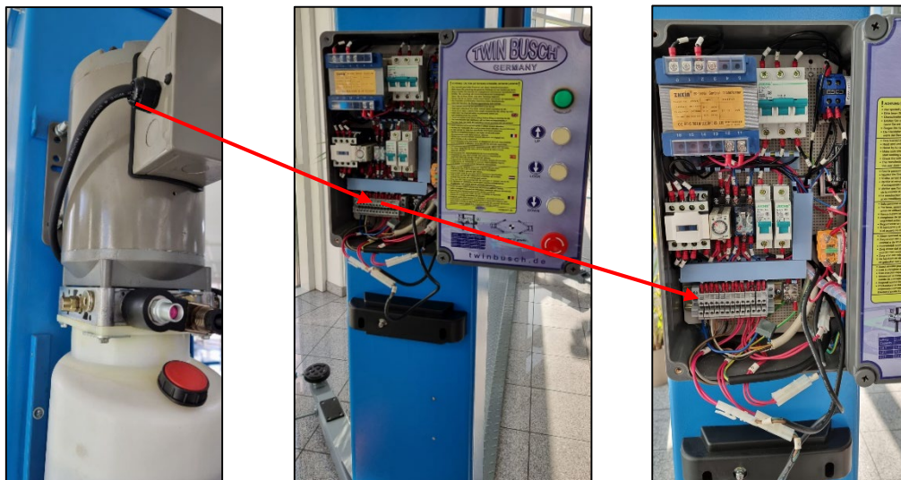
Figure : Connexion de l'alimentation au panneau de commande
