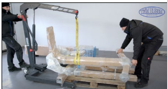
Abbildung: Unterlegung der Tragarm-Einheit
