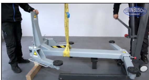
Abbildung: Ausrichten der Tragarm-Einheit
