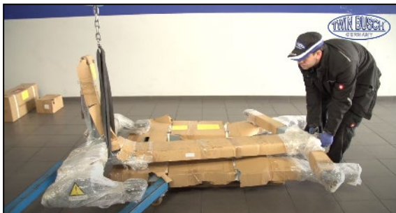
Abbildung: Bewegung des Tragarms mit Hebegurt
