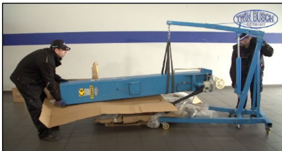
Abbildung: Bewegung der Säule mit Motorkran
