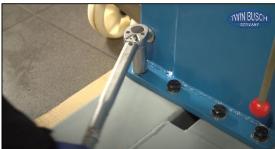
Abbildung: Sechskant-Schrauben festziehen
