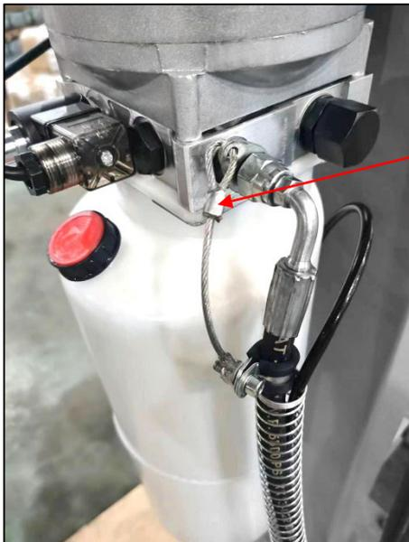
Stahlseil zur Sicherung
