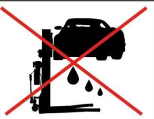
Hebebühne vor Feuchtigkeit schützen! Elektrische Anschlüsse müssen zwingend trocken sein!
