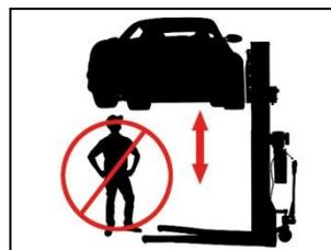
Der Aufenthalt von Personen (beim Heben oder Senken) unter der Hebebühne ist verboten!
