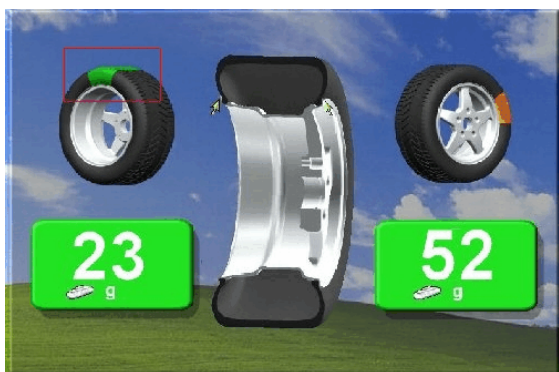
Fig. 58 indicazione peso fianco interno
