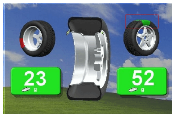
Fig. 59 indicazione peso fianco esterno
