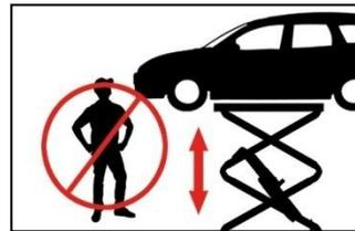
Der Aufenthalt von Personen (beim Heben und Senken) unter der Hebebühne ist verboten!
