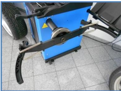
Motorradadapter montieren und mit den beigelegten Schrauben befestigen. (Adapter muss plan auf der Wuchtglocke sitzen)
