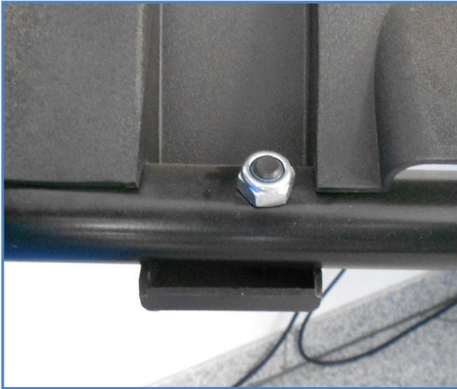
Mutter der Schutzhaube abmontieren und die Haube auf die zweite Stufe verlängern.
