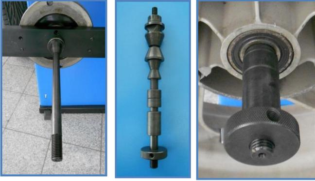
Adapterwelle montieren, passende Konusse und Buchsen wählen, Motorradfelgen montieren.
