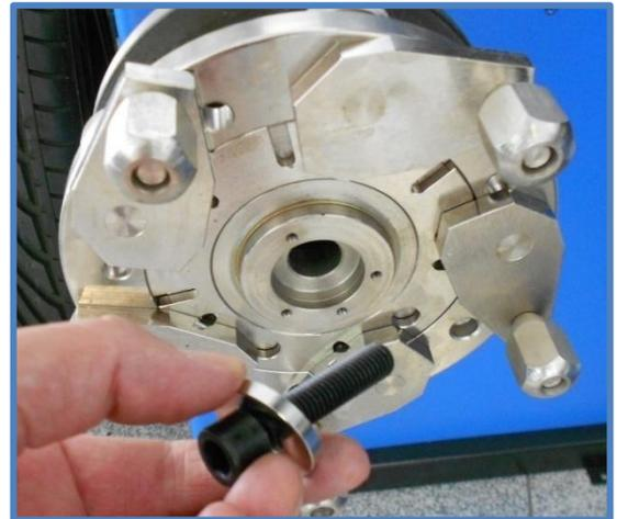
Die Unterlegscheibe befindet sich unter einer der Muttern.
