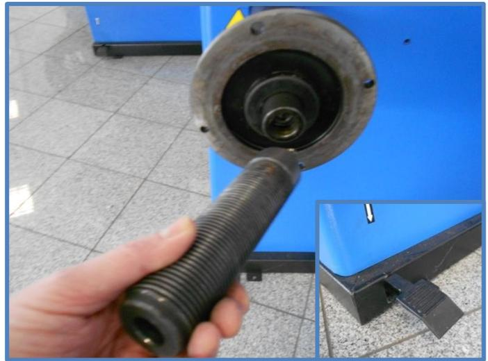
Mit einem 8mm Inbusschlüssel die Hauptwelle entfernen.
