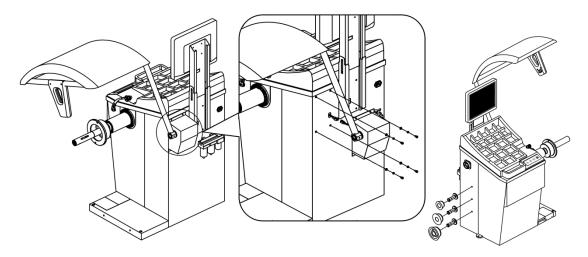
Abbildung 7: Montage der Radabdeckung / Schutzabdeckung
