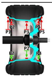
Abbildung 22: Befestigungspunkte der Wuchtgewichte
