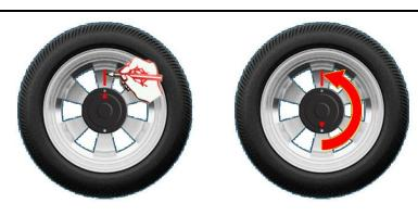
Abbildung 56: Markierung für Wellennullkalibrierung
