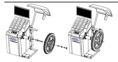
Abbildung 49: Motorradradbefestigung an der Reifenwuchtmaschine
