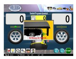
Abbildung 26: Automatisches Messen der Radbreite
