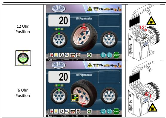
Abbildung 34: statisches Auswuchten (oben: 12 Uhr, unten: 6 Uhr)
