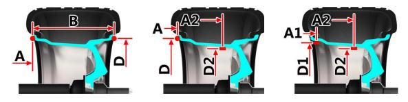
Abbildung 16: Radparameter (links: Parameter A B D, mitte: EALU2 Parameter, rechts: EALU1 Parameter)
