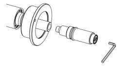
**Abbildung 6: automatik Wellenmontage**
