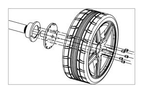
Abbildung 13: Montieren von Rädern ohne Mittelloch
