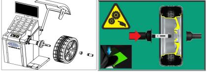
Abbildung 11: Radmontage / Demontage (links oben: positive Positionierung, recht oben: Animation (montieren), links unten: negative Positionierung, rechts unten: Animation (demontieren))
