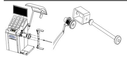
Abbildung 47: Motorradrad-Wuchtaufnahme
