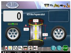
Abbildung 46: Motorradradwuchtmodus (links: dynamisch, rechts: statisch)
