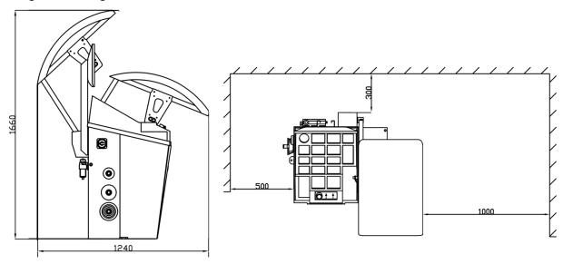
**Abbildung 5: Hauptabmessung und Arbeitsbereich**
