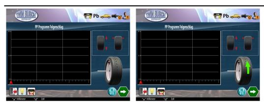
Abbildung 51: Felgenrundlauf und Axialschlag Messung
