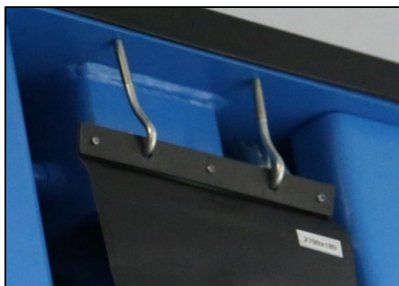
Figure : Montage de la protection de chaîne et de butée de porte
