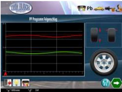
Figure 52 : résultats de la mesure du faux-rond et du voile latéral
