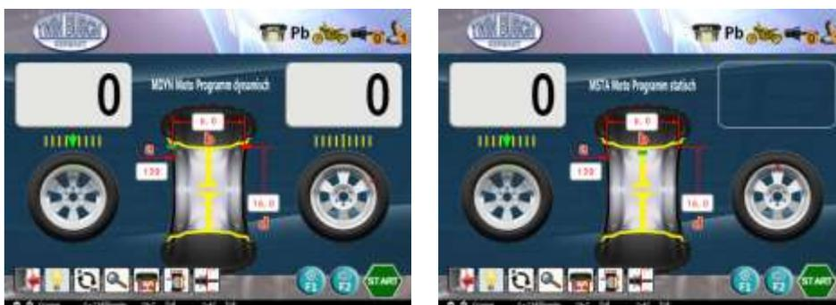
Figure 46 : mode d'équilibre pour roues de moto (à g. : dynamique, à d. : statique)
