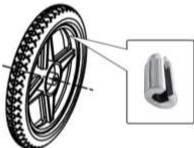
Figure 50 : masse d'équilibrage pour roue de moto
