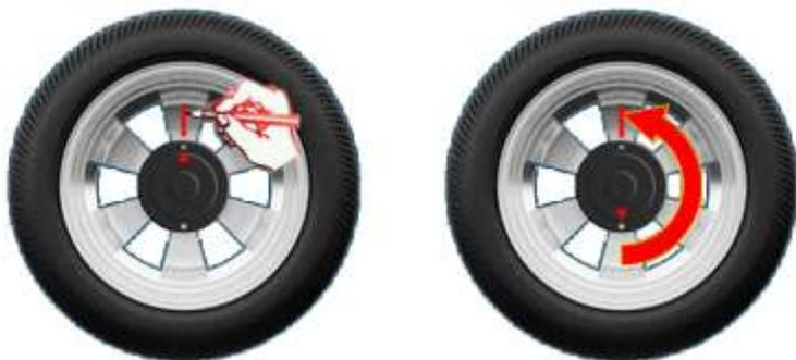
Figure 56 : marquage pour l'étalonnage du point zéro de l'axe
