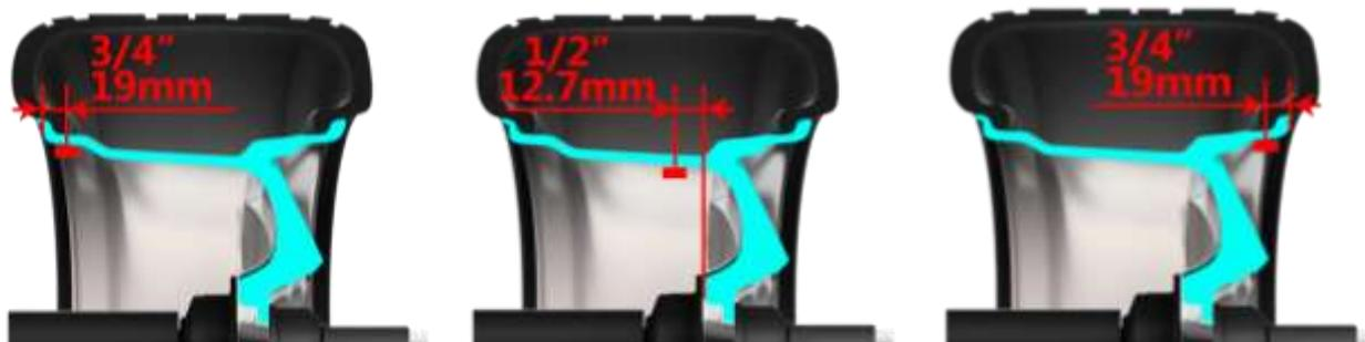
Figure 24 : positions de collage des masses (à g. : P2, au milieu : P3, au d. : P4)
