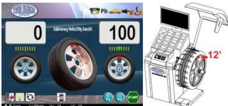
Figure 58 : programme d'étalonnage de la masse – étape 2
