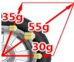
Figure 45 : répartition des masses en mode SPL
