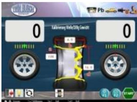
Figure 57 : programme d'étalonnage de la masse – étape 1
