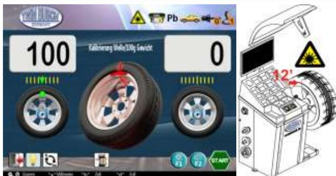
Figure 59 : programme d'étalonnage de la masse – étape 3
