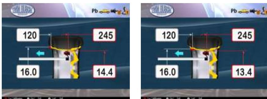
Figure 17 : mesure des valeurs A D (à g. : EALU2, à d. : EALU1)
