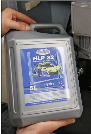
Figure : Remplissage avec de l'huile HLP 32
