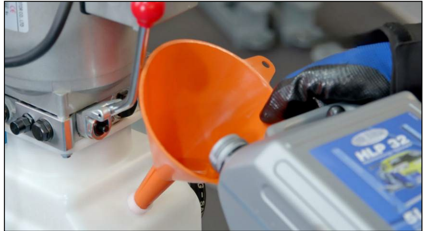
Figure : Remplissage avec de l'huile HLP 32
