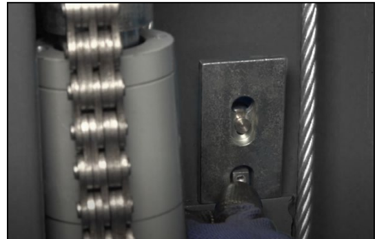
Figure : crans de sécurité avec équerre de fixation
