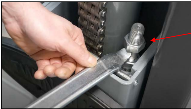
Figure : Tension du câble
