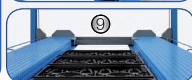
(1) Exemple de montage de 3 ponts Parking (2) Traverse anti-goutte (3) Rampes d'accès larges (4) Plaques de déport en option (de ce fait, la largeur totale du pont passe de 2900 mm à 1640 mm) (5) Protection contre les écrasements de pieds (6) Câles incluses (7) Moteur puissant (8) Déverrouillage manuel des crans de sécurité (9) En option: Récupérateur d'huile
