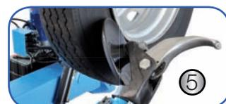
(1) Deux puissants moteurs d'une puissance de 2,2 kW chacun (2) Griffes de serrage précises de qualité supérieure avec une grande plage de serrage, pour des roues pouvant aller jusqu'à 42 pouces et un diamètre maximal de 2300 mm (3) Commande flexible par joystick (4) Pédale à pied pour une commande précise (5) Détalonneur flexible sur le bras de montage / démontage
