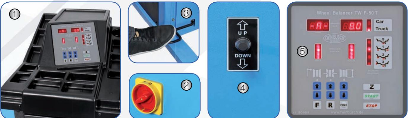
(1) 13 emplacements pour consommables (2) Interrupteur ARRÊT / MARCHÉ (3) Frein de roue (4) Commande par joystick (5) Saisie facile et rapide des données, nouveau design pour une lecture des données et une ergonomie optimales
