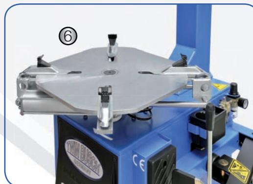
(1) Détalonneur puissant (2) Bras d'assistance supplémentaire (3) Tête de montage (4) Réglages par joystick (5) Pédales ergonomiques (6) Griffes de serrage | Grande plage de serrage Ext: 10" jusqu'à int. 24"
