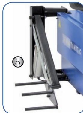
(1) Bras d'assistance supplémentaire (2) Tête de montage (3) Gonfleur intégré (4) Fixation de la jante par trou central, cône et pince de serrage rapide (5) Elévateur de roue
