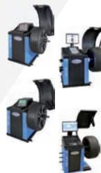
La **TW F-00** dispose, comme la **TW F-23** et **TW F-95** d'un carter plus imposant que celui de la **TW F-150**. La **TW F-00** est équipée d'un axe fileté extrêmement long de 255 mm, très avantageux pour les jantes larges. Le diamètre de l'axe fileté de la **TW F-00**, **TW F-23** et **TW F-95** est de 40 mm, celui de la **TW F-150** seulement de 36 mm. Les roulements internes des **TW F-00**, **TW F-23** et **TW F-95** sont plus imposants et robustes.
