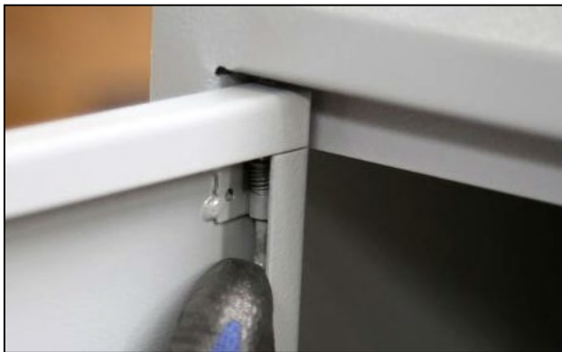
Abbildung: Aushängen der Schaltkastentür
