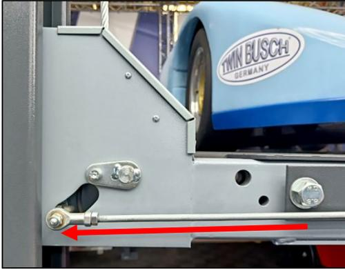
Abbildung: Lange Entriegelungsstange
