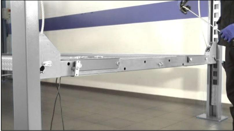
Abbildung: Gestänge mit Kugelement
