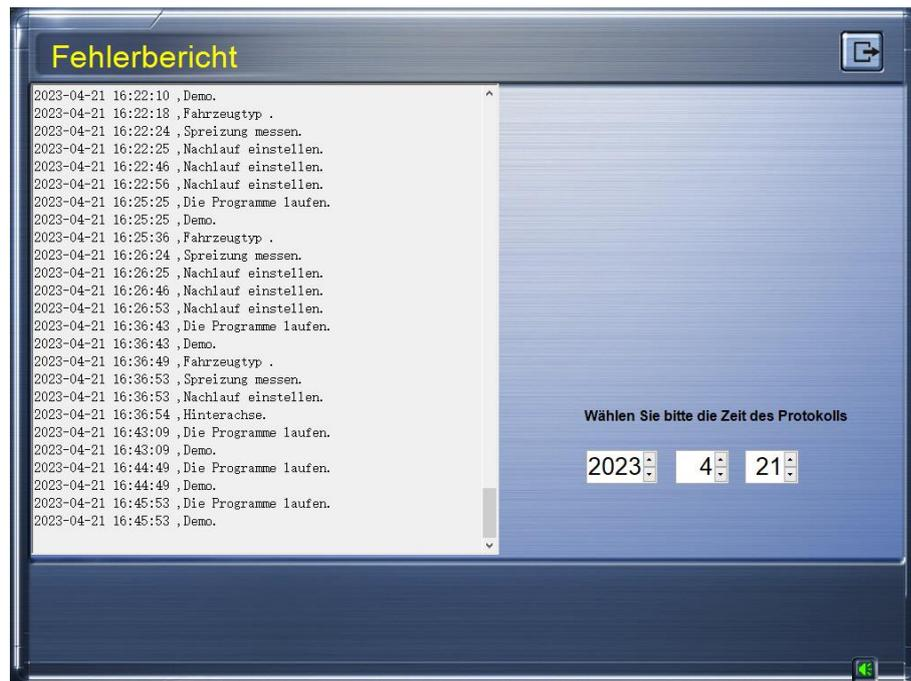
Der Fehlerbericht zeichnet hauptsächlich den Arbeitsstatus der Kamera auf, wenn die Messvorrichtungen im Sichtbereich sind. Sie liefert dem Servicetechniker eine Entscheidungsgrundlage für die Bereitstellung von Remote-Support.
