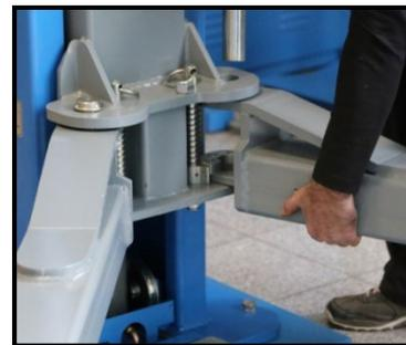
Abbildung: Montage der Tragarme am Hubschlitten
