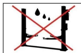
Hebebühne vor Feuchtigkeit schützen! Elektrische Anschlüsse müssen zwingend trocken sein!
