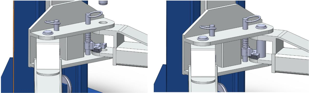
Tragarm einführen, dabei die Tragarmverdrehungssicherung anheben. Bolzen einführen und mit Sicherungsring sichern.
