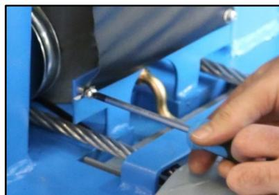
Abbildung: Montage des Ketten- und Türanschlagsschutzes
