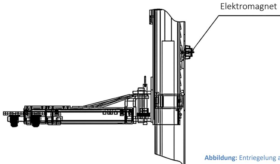
Abbildung: Entriegelung aller Elektromagnete
