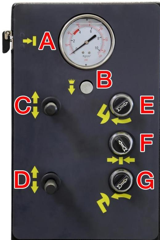
**Schritt 4:** Fahren Sie den Kipparm nach vorne und bringen Sie den Montagekopf in Position am Felgenreand.
