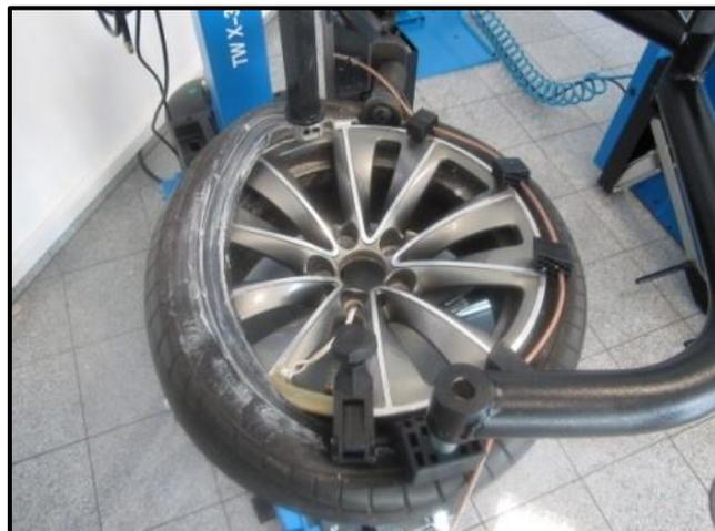
Mit Drehrichtungspedal weiter drehen bis Wulst überspringt.
