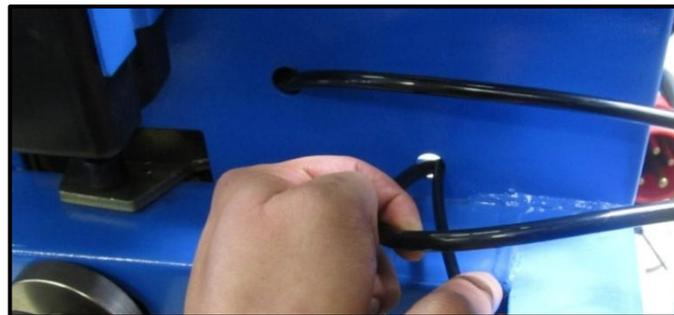
Luftschläuche an dem Zylinder entsprechend Ihrer Länge (kurz → oben / lang → unten) und an dem "T" Stück hinter dem Abdruckzylinder im Innenraum der Maschine montieren. (Schlauch zur Wartungseinheit).
