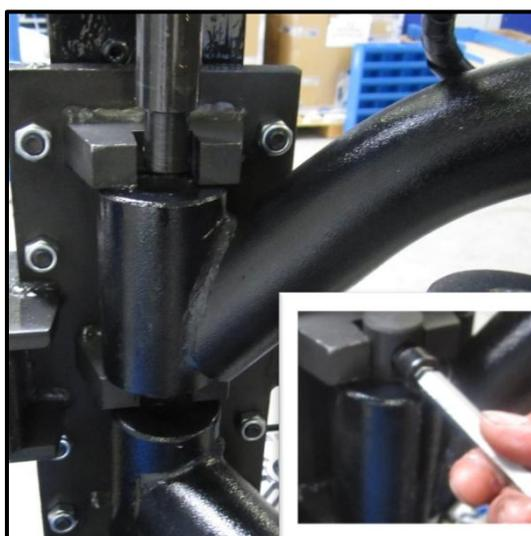
Stange des Reifenniederdrückers und Anschlagscheibe (diese spezielle Unterlegscheibe dient als Stopper für die Stange und muss überstehen) montieren.
