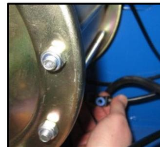
Montieren Sie den Reifenfüller.
