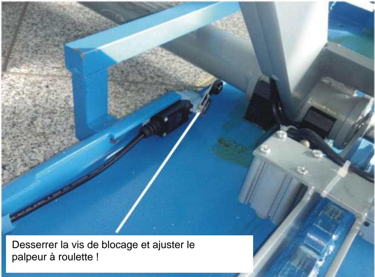
Desserrer la vis de blocage et ajuster le palpeur à roulette !
