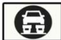
Le véhicule doit obligatoirement être parallèle à la plateforme.
