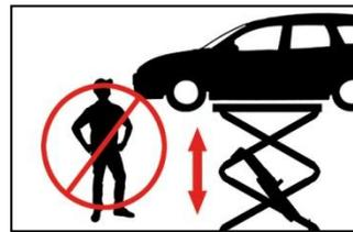
Der Aufenthalt von Personen (beim Heben und Senken) unter der Hebebühne ist verboten!
