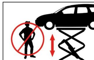
La présence de personnes (lors du levage et de l'abaissement) sous le pont élévateur est interdite !
