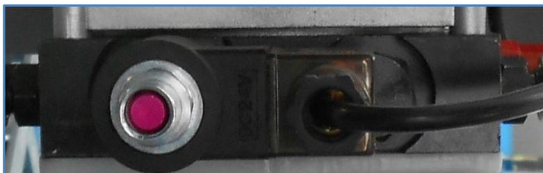
Entfernen Sie die Chromschutzhülle und drehen Sie die rote Bayonett-Schraube nach links (gegen den Uhrzeigersinn).
