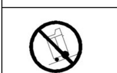
**DAS TW AC 200 MUSS BEI BETRIEB ZWINGEND AUF EINER EBENEN FLÄCHE STEHEN UND DARF AUF KEINEN FALL BEWEGT WERDEN (VIBRATIONEN VERMEIDEN)**
