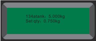
2. Beim Befüllen folgen Sie den Anweisungen des Klimaanlagen-Herstellers, die gewünschte Menge an Kühlmittel einstellen und ENTER (Enter) drücken.
