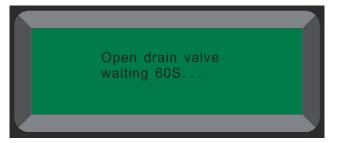
**5.** Nach 60 Sekunden ist der Ölablass-Vorgang beendet. **Hinweis:** Notieren Sie die Menge des abgelassenen Öls, um später die gleiche Menge an neuem Öl wieder zuführen zu können.
