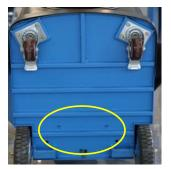
Kippen Sie unter Mithilfe einer zweiten Person das Gerät vorsichtig in eine Position, die es Ihnen erlaubt, die Bodenunterseite des Geräts zu erreichen, um die sich dort befindlichen Transport-Sicherungs-Bolzen zu entfernen.
