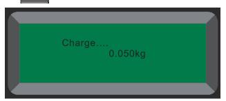
3. Der Vorgang endet automatisch, sobald die eingestellte Kühlmittelmenge umgefüllt worden ist. Auf dem Display erscheint:
