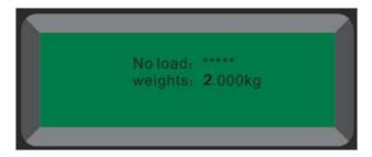
5.7 Waage mit einem 2 Kilo Gewicht beschweren, geben Sie den Wert 2.000 kg ein.
