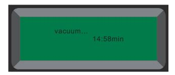
Hinweis: Sollte sich im System Kältemittel befinden und der Druck ist über 0.5 bar, wird die Vakuumphase abgebrochen.
