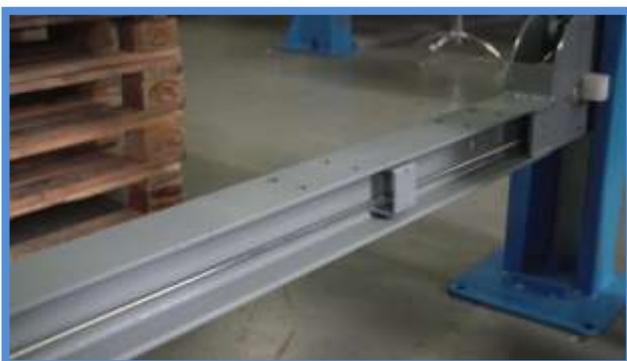
Nous retirons maintenant les câbles en acier du chemin de roulement gauche. Le câble court sera positionné sur la colonne avant gauche et le câble long sur la colonne avant droite.
