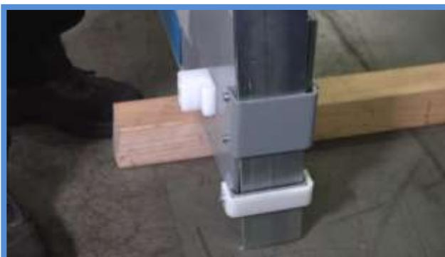
Les rails de sécurité peuvent maintenant être réinsérés dans les colonnes. Insérez tout d'abord les tiges filetées dans les colonnes, puis remplacez l'extrémité inférieure des rails de sécurité dans les logements prévus à cet effet sur l'arrière des colonnes. Si nécessaire, tournez légèrement les colonnes lors de l'insertion de la traverse.
