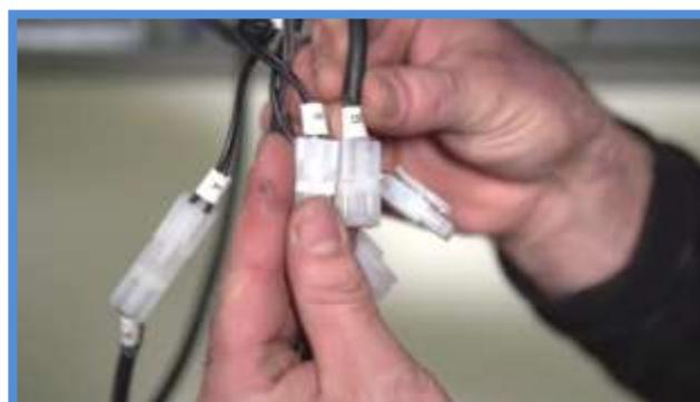
Enfichez le connecteur du contacteur de fin de course à actionnement par câble détendu sur le connecteur correspondant du câble à connecteurs multiples.
