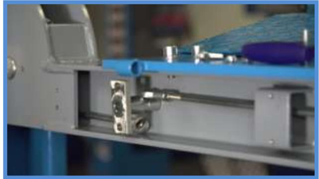
Avant de visser le mécanisme de déverrouillage, il est nécessaire de positionner la tige. Posez pour cela la tige droite sur la tige filetée. Après le montage, les tiges sont ainsi verrouillées ou déverrouillées au moyen d'une seule rotation dans le sens des aiguilles d'une montre.
