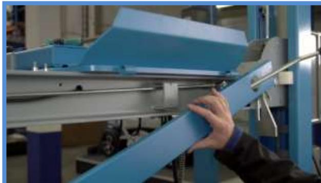
Avant de remettre les tôles de recouvrement internes, vérifiez le bon cheminement des câbles. Si possible, fixez-les au moyen des attaches fournies afin de les tenir éloignés des pièces mobiles.
