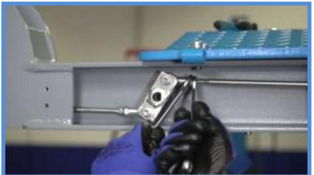
Notre conseil : pour le placement des écrous sur la face arrière, nous vous recommandons l'utilisation d'une clé à anneau.
