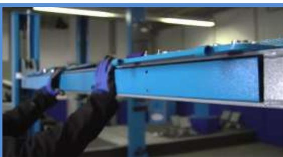
Passons maintenant à la partie arrière du pont. C'est là que le levier de déverrouillage doit être placé. La tige gauche doit être posée sur la tige filetée, afin de pouvoir effectuer le déverrouillage dans le sens des aiguilles d'une montre.
