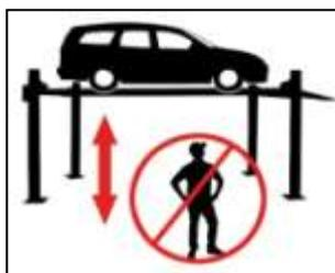
Le stationnement de personnes sous le pont élévateur est interdit (lors de la montée / descente) !
