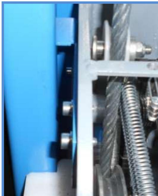
Occupons-nous maintenant du bloc moteur. Avant de suspendre le moteur, il est nécessaire d'insérer deux vis, à gauche et à droite respectivement, avec rondelle en caoutchouc, entretoise, circlip et écrou. Le bloc moteur peut ensuite être suspendu à la colonne principale et les vis de fixation inférieures peuvent être insérées.
