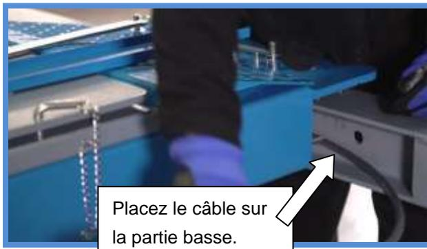
Lorsque vous insérez les câbles, veillez à ce qu'ils soient bien posés en prévision de la mise sous tension ultérieure. Sur le côté principal avec le vérin hydraulique, veillez à ce que le câble en acier passe sous la tige filetée.
