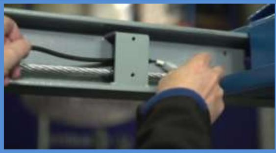
Installez maintenant le système de verrouillage sur la partie avant du pont. Retirez le circlip de la tige filetée et placez-le devant l'écrou.
