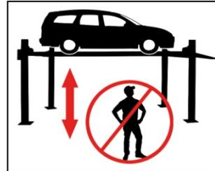
Il est interdit de stationner sous le pont élévateur (lors de la montée ou de la descente) !
