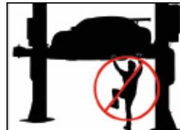
Il est strictement interdit de grimper sur le pont élévateur !
