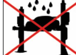
Protéger le pont élévateur de l'humidité ! Les raccordements électriques doivent impérativement être secs !
