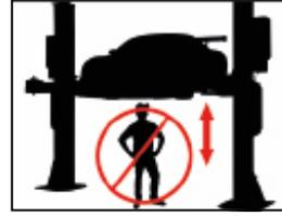
La présence de personnes (lors du levage ou de l'abaissement) sous le pont élévateur est interdite !
