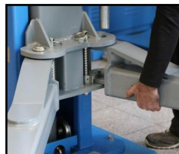
Figura: Montaggio dei bracci di supporto sul carrello di sollevamento
