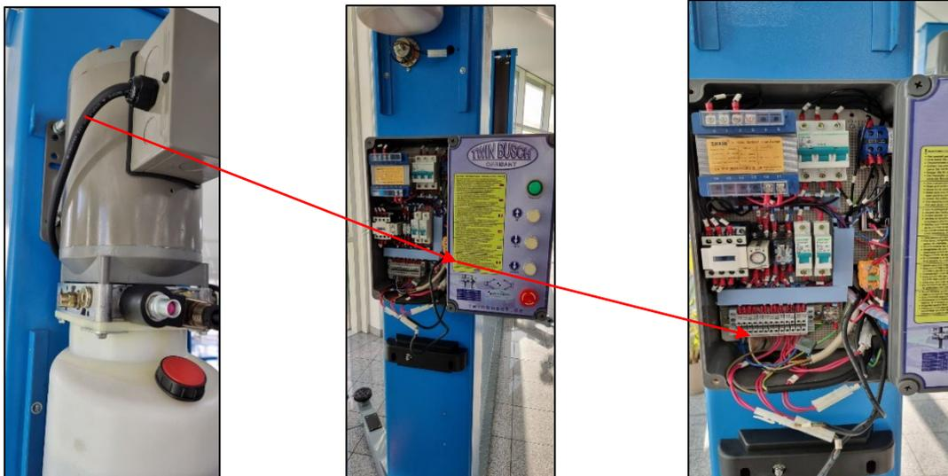
Illustration : connexion de l'alimentation électrique à l'unité de commande
