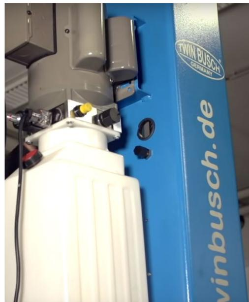
Figure : Montage de l'unité moteur
