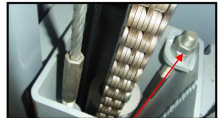
Filettatura per regolare la tensione del cavo d'acciaio
