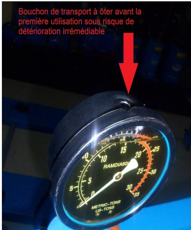
1. **REMARQUE** : avant la première utilisation de la machine, purgez le système hydraulique afin d'éliminer tout l'air. Ouvrez la soupape de sécurité en la tournant dans le sens contraire des aiguilles d'une montre. Appuyez plusieurs fois sur la poignée de la pompe afin d'éliminer tout l'air présent dans le système.
