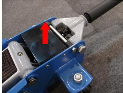
3. Entfernen Sie bei geöffneter Buchse die Öleinfüllschraube.
