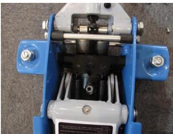
4. Füllen Sie Öl durch die Ölbohrung und stellen Sie sicher, dass der Ötoberflächenstand oben am Öltank weniger als 11 mm beträgt.
